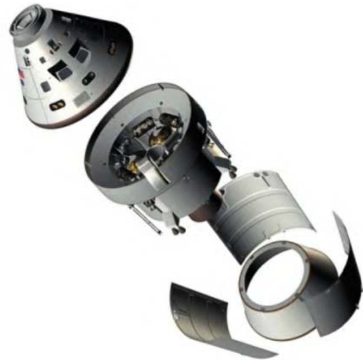
Детали корабля «Орион», сверху вниз: возвращаемый аппарат, служебный модуль, адаптер для крепления на ракете-носителе
