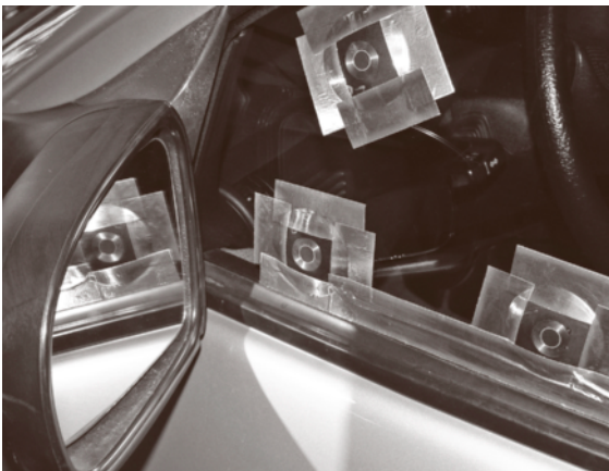
Fig. 16.58 Test set up with surface microphones according to Brüel and Kjaer (Photo courtesy Forschungsinstitut für Kraftfahrwesen und Fahrzeugmotoren Stuttgart (FKFS))
