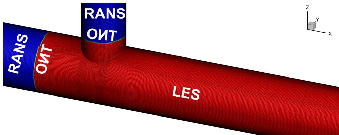
Рис. 5.5. Разбиение расчетной области на подобласти в задаче о течении в T-образном соединении двух труб
