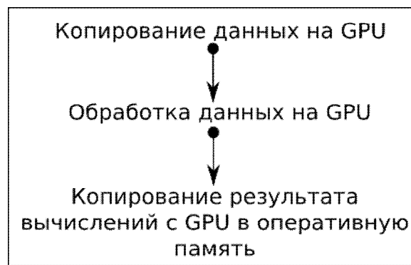
Рис. 6 Схема работы с графическим процессором
