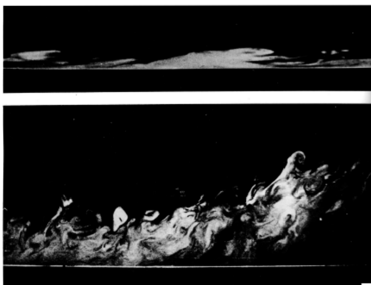
164. Эффекты сильных градиентов давления. При сильном благоприятном градиенте давления (верхний снимок) турбулентный пограничный слой растягивается и в конечном итоге реламинаризуется; при сильном обратном градиенте (нижний снимок) слой утолщается и отрывается. Фото Р. Е. Falco. [Head, 1982]
