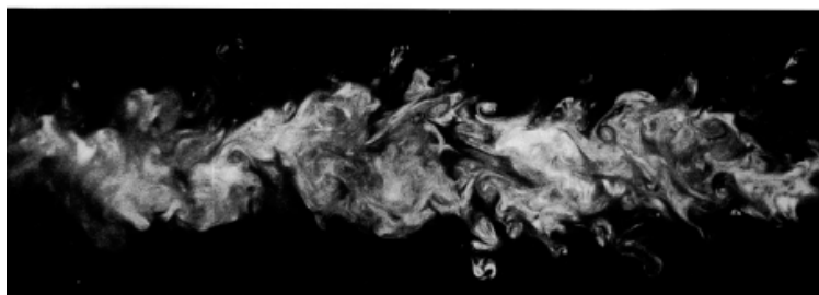
174. Турбулентный след за цилиндром. Лазерный световой нож прорезает след за круговым цилиндром при числе Рейнольдса 1770. Масляный туман демонстрирует мгновенную структуру течения, охватывая поле в 40 диаметров цилиндра по обе стороны от сечения, отстоящего на 50 диаметров вниз по потоку. Фото R. E. Falco
