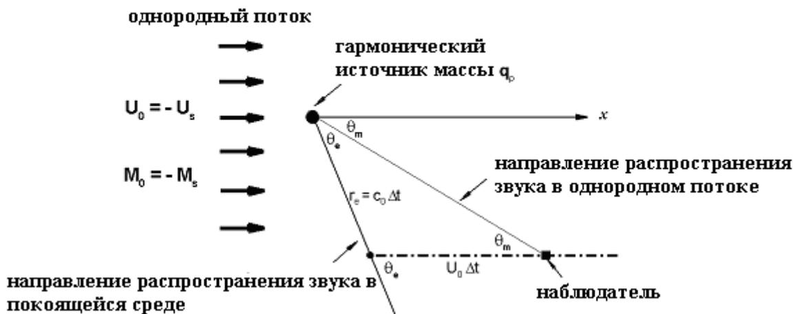
Рисунок 2.2. Схема постановки задачи о волновом источнике
