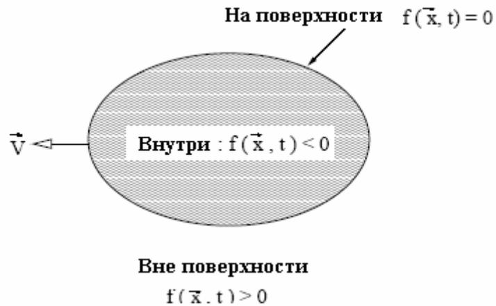
Рисунок 1.1. Определение контрольной поверхности в методе FWH.
