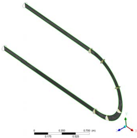
Рисунок 16 – Характерные сечения канала с поворотом
