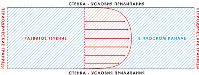
Рис. 9. Схема течения и граничные условия для задачи моделирования течения в плоскопараллельном канале.
