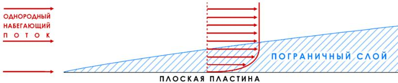
**Рис. 11. Схема течения в пограничном слое на плоской пластине.**
