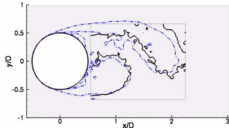
Сравнение расчетных и экспериментальных осреднённых по фазе характеристик при турбулентном обтекании цилиндра
